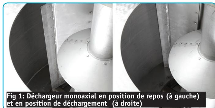
Fig 1: Déchargeur monoaxial en position de repos (à gauche) et en position de déchargement (à droite)
