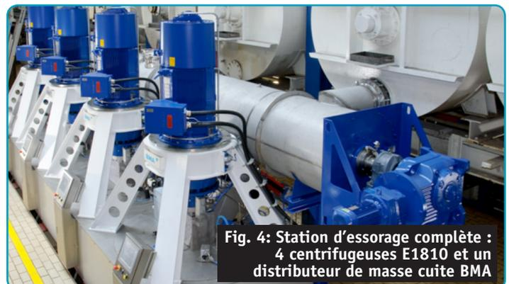
Fig. 4: Station d'essorage complète : 4 centrifugeuses E1810 et un distributeur de masse cuite BMA
