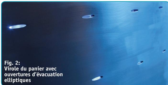
Fig. 2: Virole du panier avec ouvertures d'évacuation elliptiques
