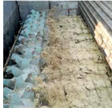
Der BMA-Diffuseur ist ein liegend angeordneter, freistehender und vollständig umschlossener Kettenförderer mit rechteckigem Querschnitt. Die obere Abdeckung ist als Dampfhaube ausgebildet und abgerundet, der Spezialboden begünstigt den Saftfluss.
